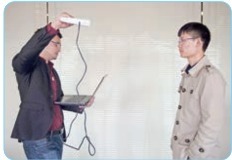
图1.2.10 利用手持三维扫描仪扫描人体
