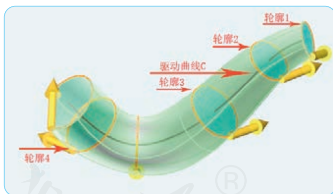
图2.1.18 二维轮廓线经过放样得到三维模型
