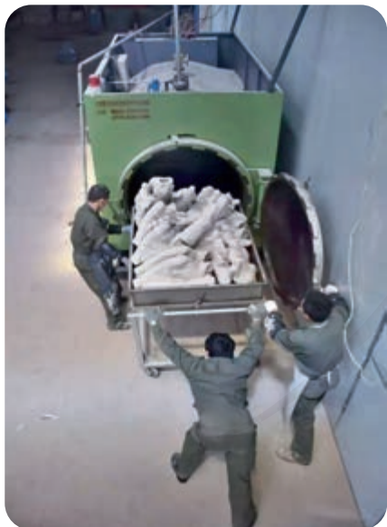
4. 制壳。用精致石英砂一层一层把制作好的蜡型包起来，然后再用高温把壳里面的石蜡烧净。
