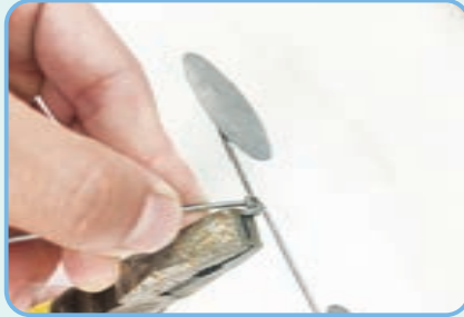
12. 将粘有铁片的铁丝用钳子弯出一个小圆扣，与其他铁丝连接在一起，组成可活动的结构。
