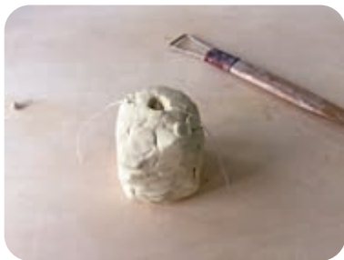
5. 用雕塑刀在雕塑泥顶端修出注浆口。
