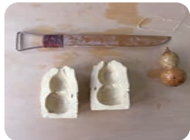
7. 将两片外模小心打开, 将葫芦取出并修整模具。合模, 尽可能保证模具完美贴合。
