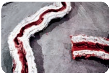
3. 蜡型灌制。把熔化好的石蜡灌到已经制作好的石膏模具或硅胶模具里，石蜡冷却后就成了蜡型。
