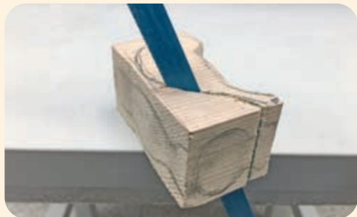
6. 沿着草图的轮廓线锯木块，但不锯透，以确保草图的完整性。
