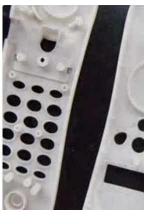
▲ 运用真空复模技术成型的模型零件 〔以硅胶为模具，以PU（聚氨酯）为材料〕
