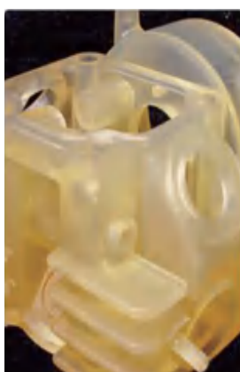
▲ SLA激光成型的模型零件 （以光敏树脂为材料）
