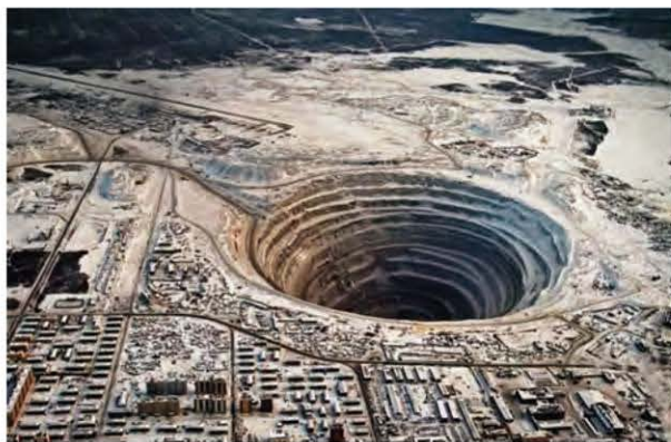
俄罗斯米尔钻石矿遗留的矿坑面积巨大（直径约1 200米，深约525米），是人类工业文明的重要遗址。
