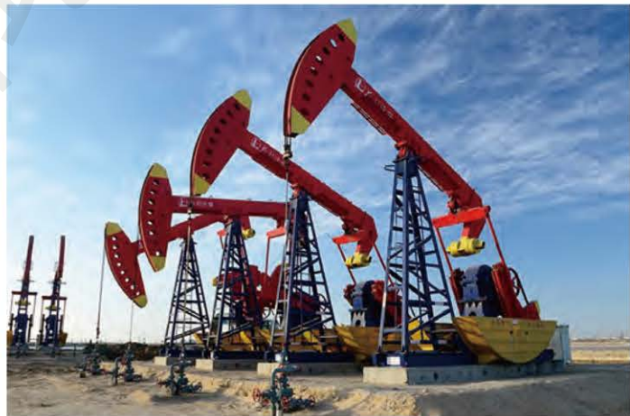
图2-2-5 山东东营胜利油田的“磕头机”（开采石油的抽油机俗称“磕头机”）
