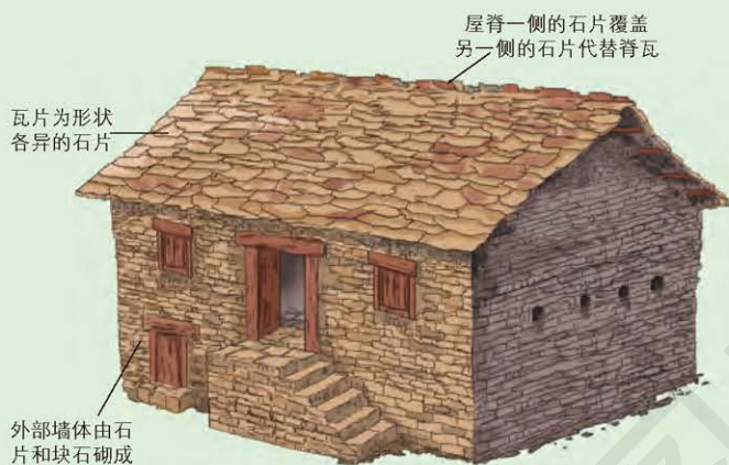
图1-2-1 石板房结构示意图
