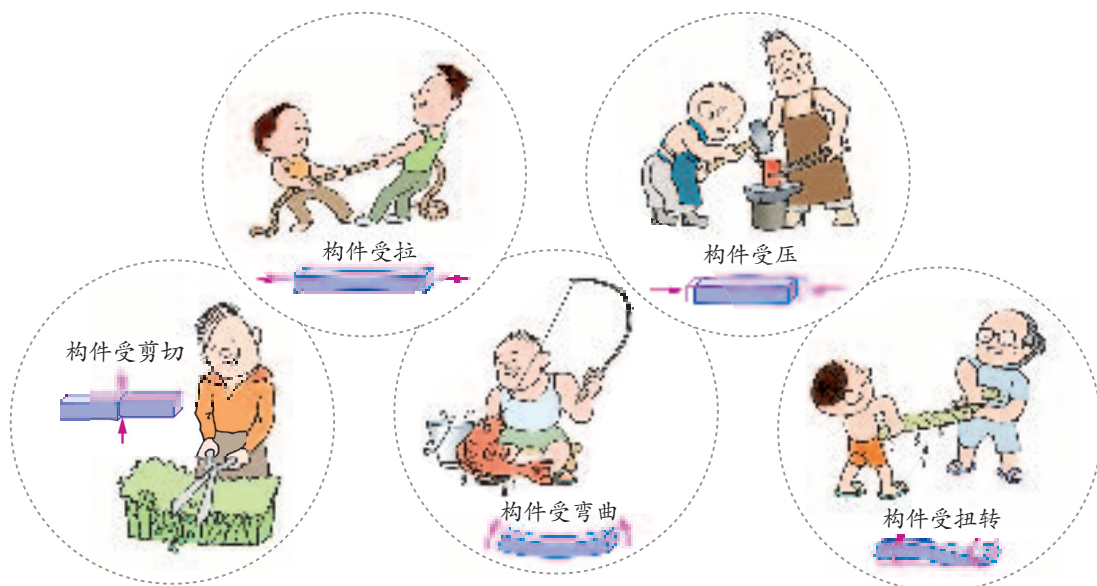
图 1-9 构件受力与变形的基本形式
