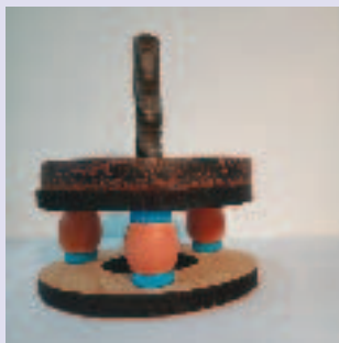
图 1-15 鸡蛋受力试验
