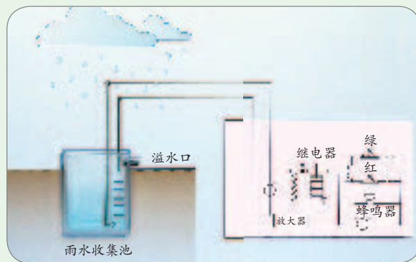
图 4-16 雨水收集池水位报警系统示意图
