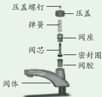
图 3-2 按压式延时水龙头装配图
