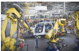
图 4-12 汽车自动装配生产线
