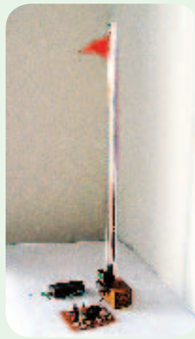
图 4-38 简易自动升旗控制装置模型
