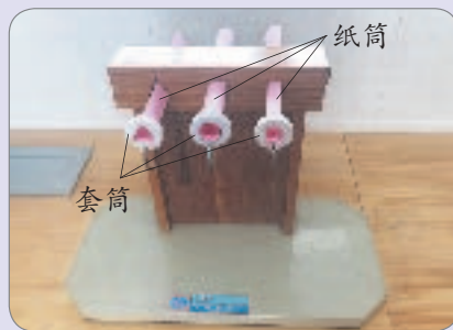
图 1-29 不同截面形状的纸筒的强度测试
