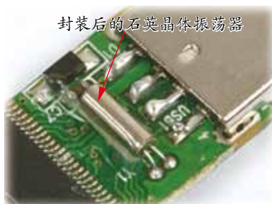
图 4-7 USB 闪存盘中的石英晶体振荡器
