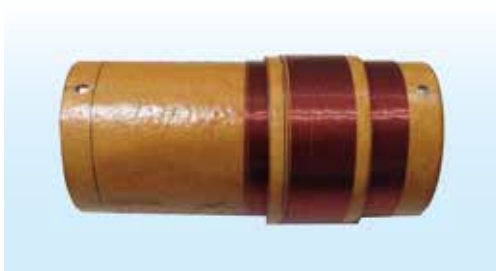
图 2-19 收音机里的自感线圈
