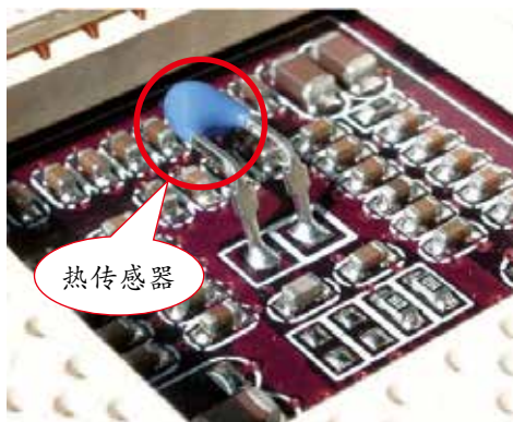
图 5-4 计算机内部的热传感器
