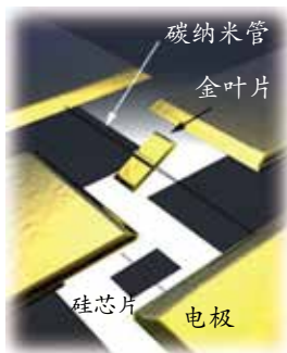
图 3-32 纳米电动机结构示意图
