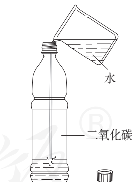
图6-15 二氧化碳的溶解性实验
