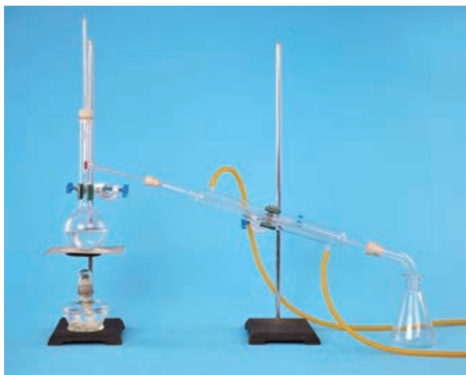
图4-20 实验室常用的蒸馏装置
