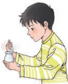
图1-5 闻气体时的正确操作
