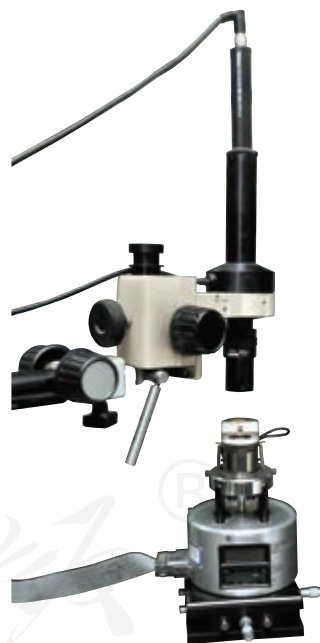
图6 扫描隧道显微镜 用于观察固体表面的原子排列情况等
