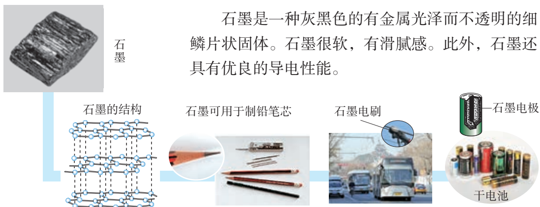
图6-2 石墨的结构及用途
