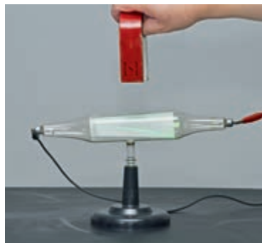
图1.2-1 电子束在磁场中受力偏转
