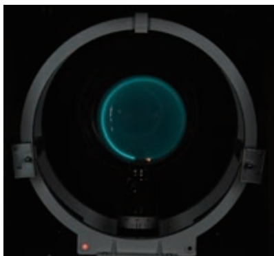
图 1.3-4 施加垂直于纸面的磁场后，电子束沿圆轨道运动
