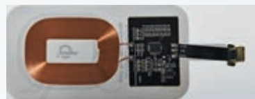
图3.3-5 无线充电接收器中的线圈
