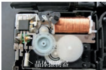
图4.1-4 石英电子钟里的晶体振荡器
