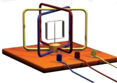
图2.3-11 产生旋转磁场的装置
