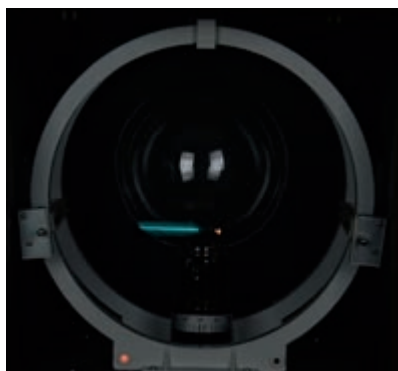
图 1.3-3 没有磁场时电子束沿直线运动
