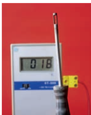
图 5.1-7 热电偶温度计
