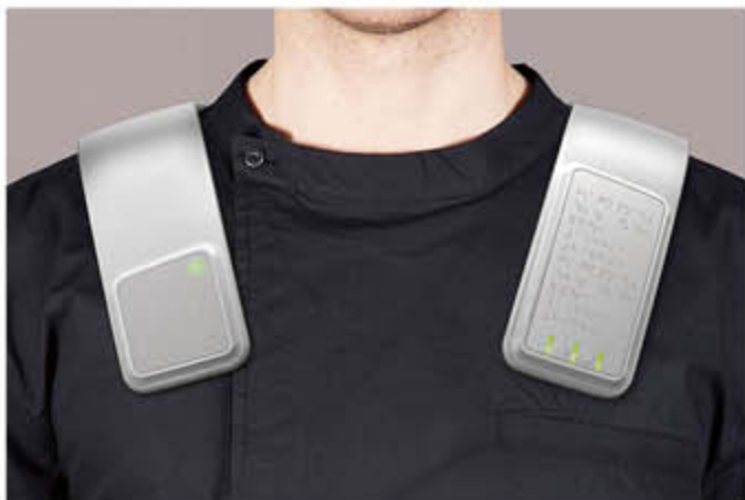
一款为盲人设计的概念手机，可以直接佩戴在肩上，触屏上的盲文可以让盲人无障碍地拨打、接听电话。
