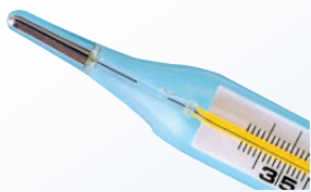
图3.1-6 体温计（细管处水银柱断开）
