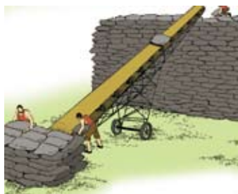
图6-5-4 传送带靠货物与传送带之间的摩擦力把货物送到高处
