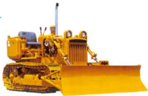
图7-1-5 推土机具有宽大的履带和锋利的土铲
