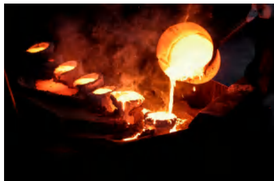
▲ 间接成型——模型浇铸
