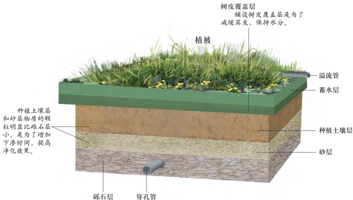
图 4-11 雨水花园结构示意图
