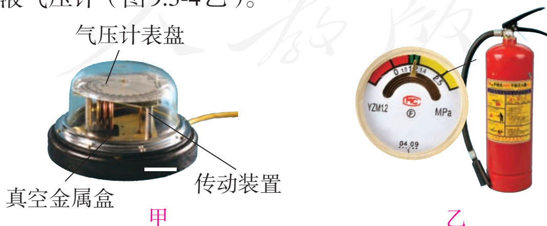
图9.3-4 无液气压计
