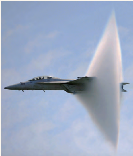
图 3-43 改变飞机的气动外形来突破音障
