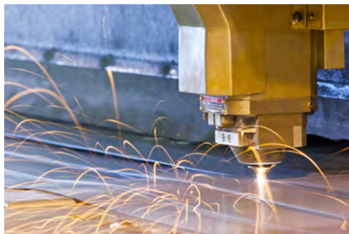
图 4-48 激光切割金属
