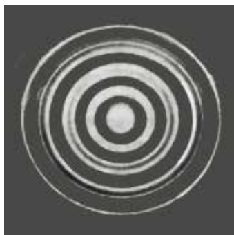
图 6-15 电子穿过多晶金箔的衍射图样
