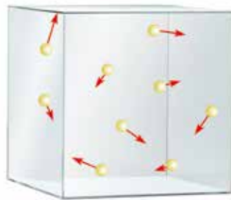
图 1-17 气体分子撞击容器壁的示意图
