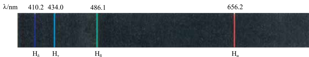
图 4-14 氢原子在可见光区域的光谱线
