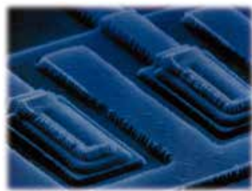
(b) 蚀刻在单晶硅片上的集成电路
