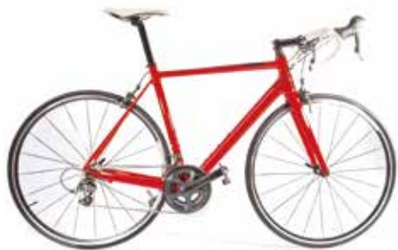
图2-31 用碳纤维制成的自行车
