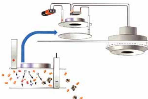
图 5-15 烟雾探测器示意图
