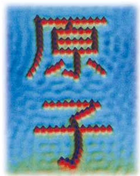
用扫描隧道显微镜移动原子构成“原子”二字
