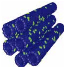
图 2-34 碳纳米管示意图
