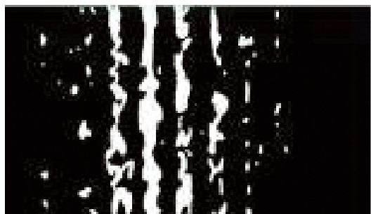
图 6-12 少量光子长时间曝光形成的图像
