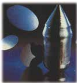
(a) 单晶硅及单晶硅片
