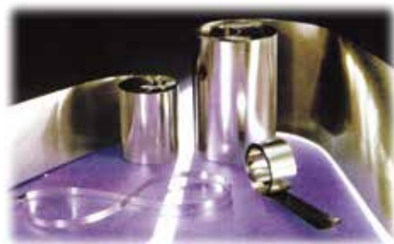
图 2-8 金属玻璃薄带
