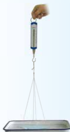
图1-6 玻璃板与水之间的分子引力实验
