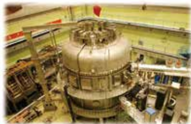
图 5-27 EAST 托卡马克实验装置
