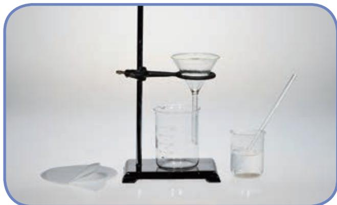
过滤时要注意“一贴，二低，三靠”。一贴是指滤纸紧贴漏斗内壁；二低是指滤纸边缘低于漏斗边缘，漏斗中的液面低于滤纸边缘；三靠是指倾倒液体的烧杯口紧靠玻璃棒，玻璃棒的末端紧靠有三层滤纸的一边，漏斗末端紧靠承接滤液的烧杯内壁。
