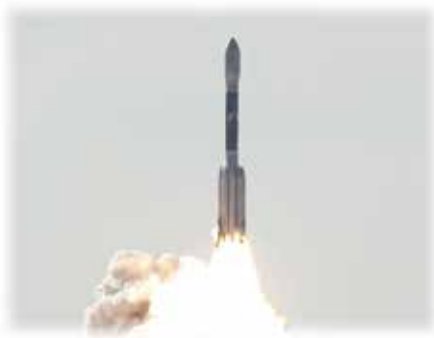
图 5-21 气体的反作用力使火箭升空
