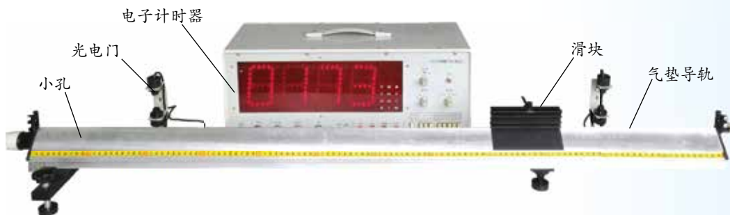
图 5-3 通过气垫导轨演示匀速直线运动
