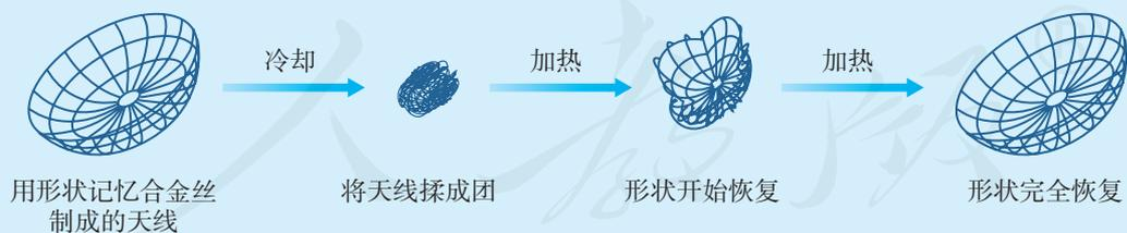
图8-6 用钛镍形状记忆合金制成的人造卫星天线
