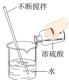
图10-7 浓硫酸稀释的正确操作
