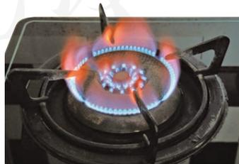
图7-30 燃气燃烧出现黄色火焰
