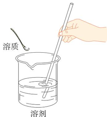
图9-3 溶液是由溶质和溶剂组成的
