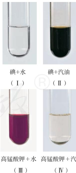
图9-4 碘和高锰酸钾的溶解性比较
