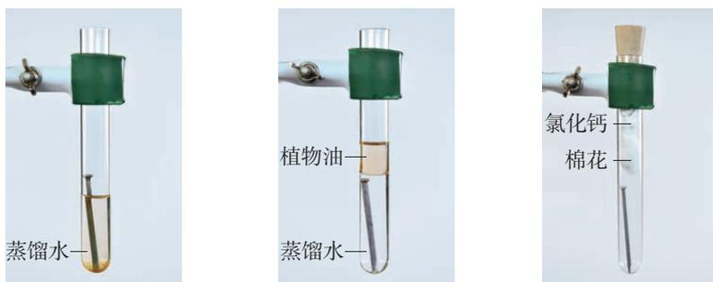
图8-20 铁钉锈蚀条件的探究
