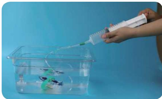
打捞沉船时，人们将数个装满水的浮筒沉入水底，绑在沉船两侧，再利用高压气体排出浮筒中的水。在浮力作用下，沉船就会慢慢浮出水面。
