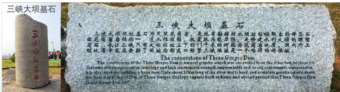
花岗岩质地坚硬，力学强度高，抗震、抗压能力强，岩体透水性微弱，是修建水利大坝的理想岩石。位于宜昌市三斗坪镇中堡岛的三峡大坝，其底部基石即为岩浆侵入地壳形成的天然花岗岩。
