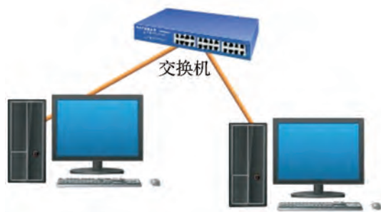
图2-3 两台计算机通过网线连接到一个交换机上
