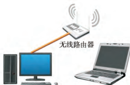
图2-5 两台计算机分别通过有线与无线方式连接到无线路由器上
