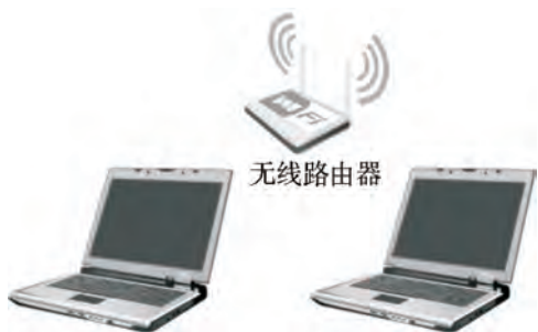
图2-4 两台计算机通过无线方式连接到一个无线路由器上
