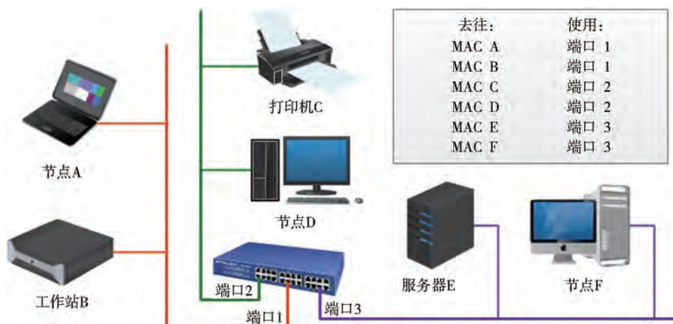
图1-28 交换机的工作原理
