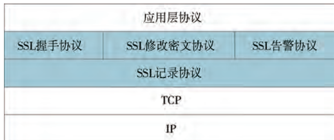
图4-10 SSL的体系结构
