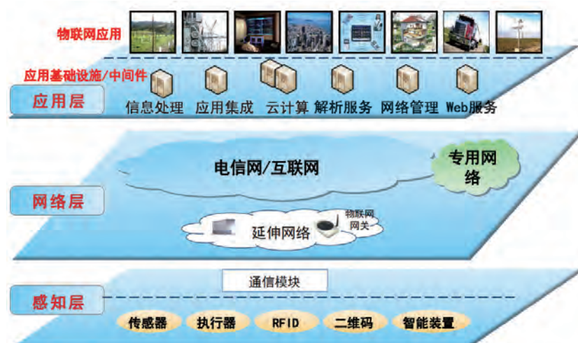
图5-3 物联网的网络架构
