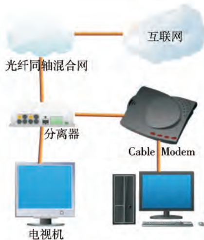
图2-7 通过Cable Modem接入互联网
