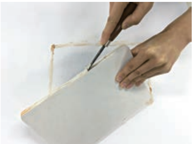
5. 将做好的石膏板移出底板，用刻刀削平板边。
