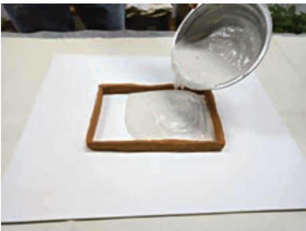
3. 将调配好的石膏浆迅速倒入模具，浇注均匀。
