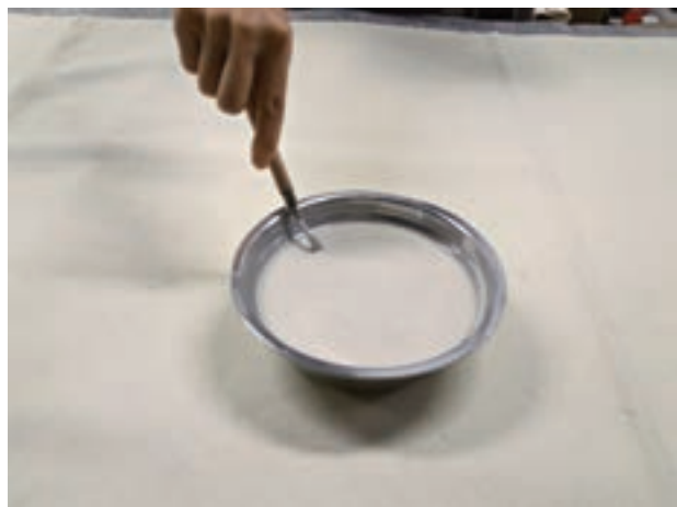
2. 准备容器，按照 1:1 的比例倒入石膏粉和水，调制成浆，注意一定要调匀。
