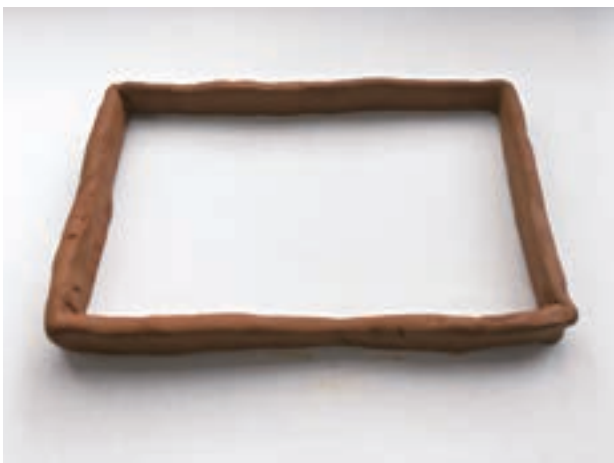
1. 用制作模具的材料围合模具形状，如圆形、方形等。
