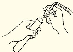
③手拿容器（切勿抵桌面），将橡皮塞慢慢转动旋进容器口。
