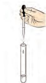
图 1-16 向试管中滴加液体
