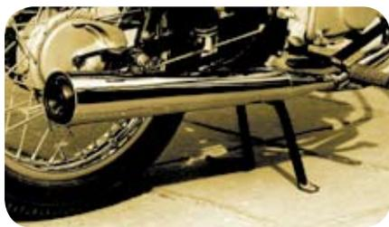
摩托车的消声器
