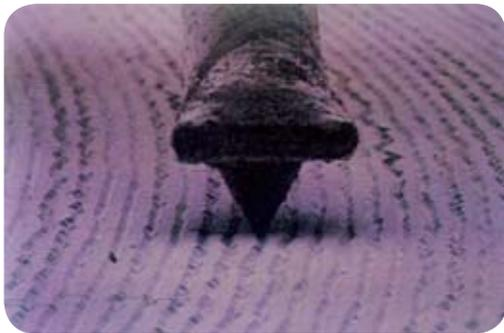
图2-1-2 木纹唱片表面记录声音的沟槽
