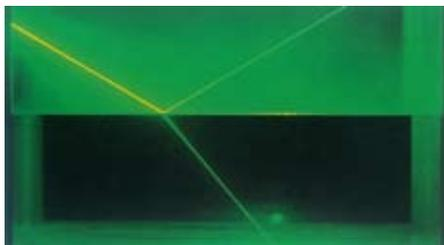
图3-4-1 光射入水中时的折射现象
