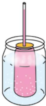
图5-4-2 装满红色水的玻璃瓶放入热水中
