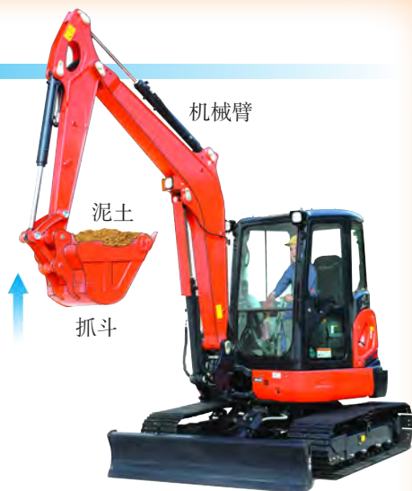
(b) 利用挖掘机挖掘、搬运泥土
