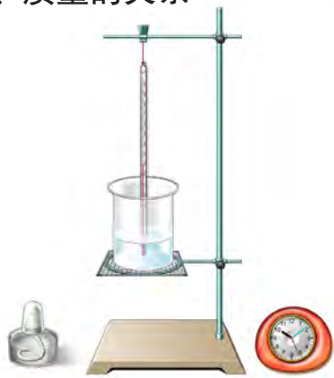
图12-8 探究水的吸热与温度变化的关系
