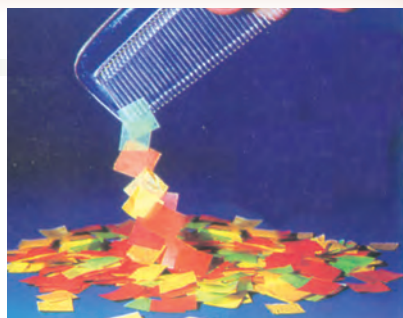
图13-2 摩擦起电实验
