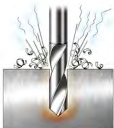
(a) 用钻头在金属块上钻孔时，钻头和金属块会发热，这是通过做功来改变物体的内能
