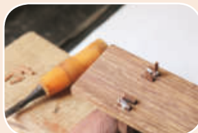
(12) 每个榫头打入两个木楔，木楔除了加固，还可以微调腿足的角度。
