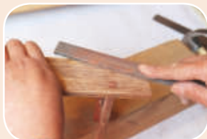
(15) 用锉刀将榫头与凳面锉平整，用细砂纸打磨光滑。
