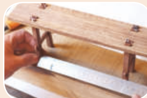
(13) 边打入木楔边度量角度变化，直到四腿角度合适。
