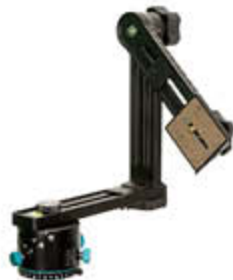
全景云台的作用是通过左右和前后的调整，保证每次转动相机的时候，相机的旋转中心始终是镜头的光学中心，不管我们如何转动相机，两者始终保持保持在同一个位置。
