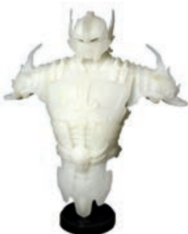
5. 通过快速成型机，打印出实体。
