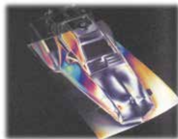
图 5-32 汽车模型显示的应力分布
