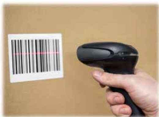
图 5-35 用激光扫描条形码
