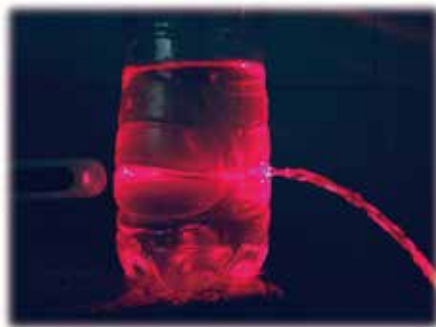
图 4-32 模拟光纤实验
