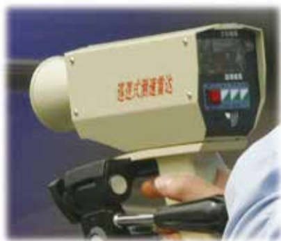
图 3-42 多普勒测速仪
