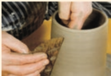
3. 拉薄坯体，然后用型板修正坯体。
