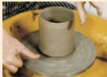
4. 用割线切下坯体，取坯。在坯体半干时进行修坯。
