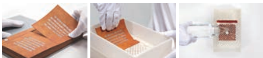
可以喝的书 丹科维斯基（美国）2015年 利用纳米材料（纳米银离子）创造出可以抗菌的纸张，能杀灭细菌，用于廉价的水过滤系统。
