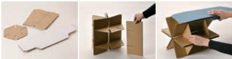
可组合的儿童椅子 渡边力（日本）1965年 取材于再生硬板纸，环保、轻巧、安全，不需要借助任何工具。 以结构来强化椅子承重程度，折叠、拼插即可。
