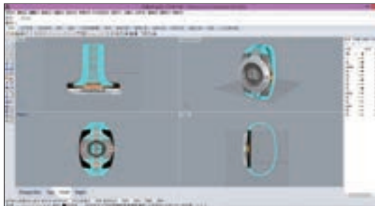
④ 电脑绘制过程：利用三维软件绘制效果图是为了便于实现产品打样，同时更好地表达设计用材、表面加工工艺以及表现处理的画面效果。
