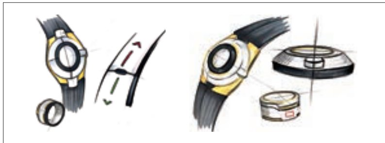
③ 手绘效果图：其表现方式多种多样，有手绘式效果图，通过铅笔、彩笔、马克笔、色粉等工具来表达，有电脑式效果图，通过二维软件或三维软件来表达。二维软件有Photoshop、Illustrator等，三维软件有Rhino、Autodesk Alias等。
