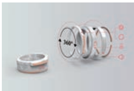
⑦ 爆炸图：按照各零件在产品整体结构中的位置，在图纸上有序地拉开距离排列，逐一绘图表示。
