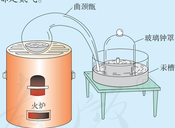
图2-4 拉瓦锡研究空气成分所用的装置
