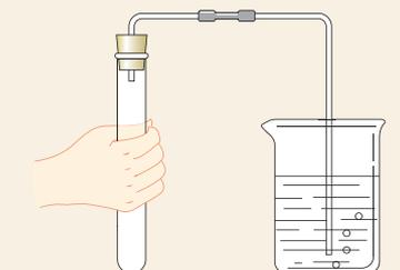
图10 检查装置的气密性
