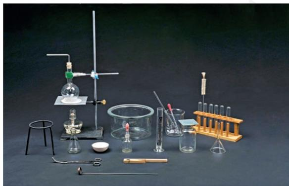
图1-8 常用的化学实验仪器
