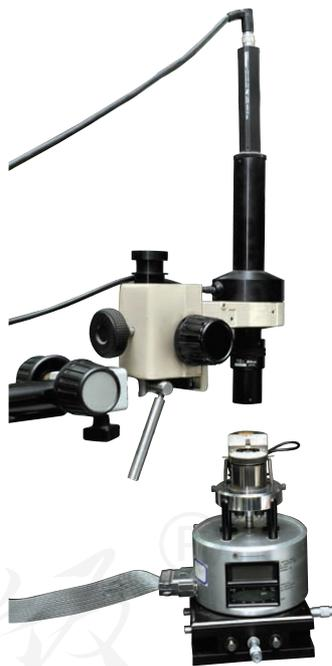
图7 扫描隧道显微镜
