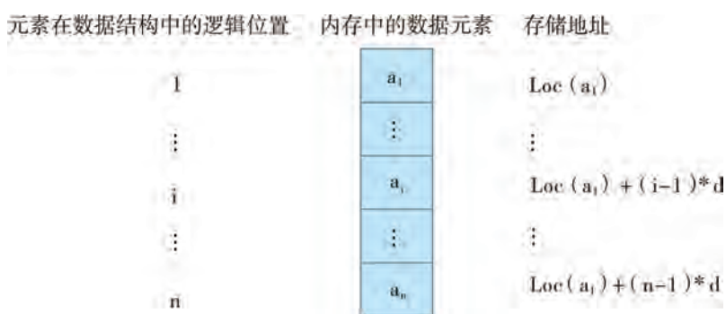
图2-3 顺序结构示意图
