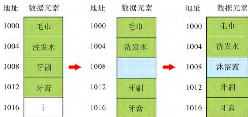
(a) 顺序存储结构插入操作
