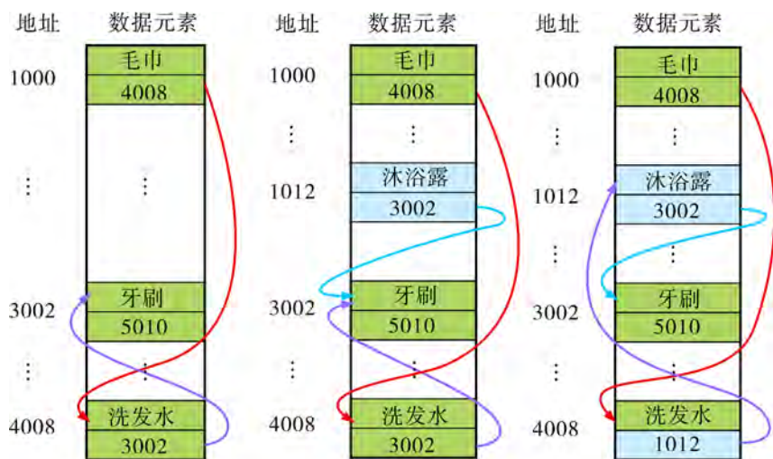
(b) 链式存储结构插入操作
