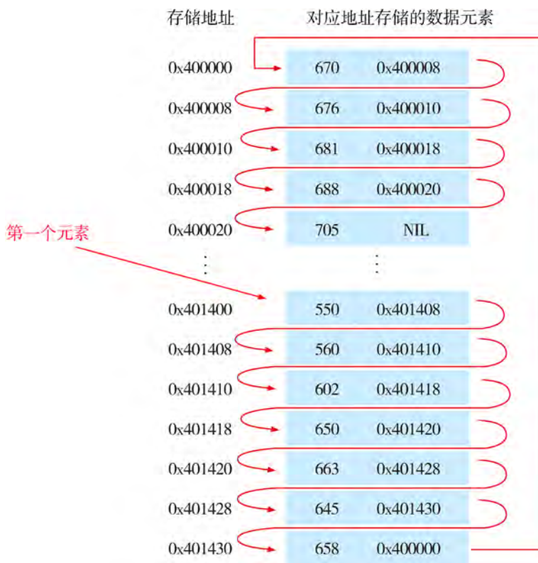
图2-4 链式结构示意图
