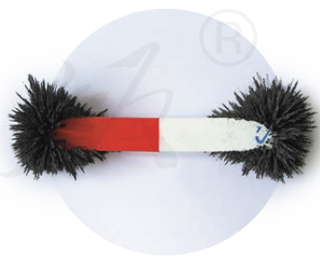
图16.1-3 条形磁体两端的磁性最强
