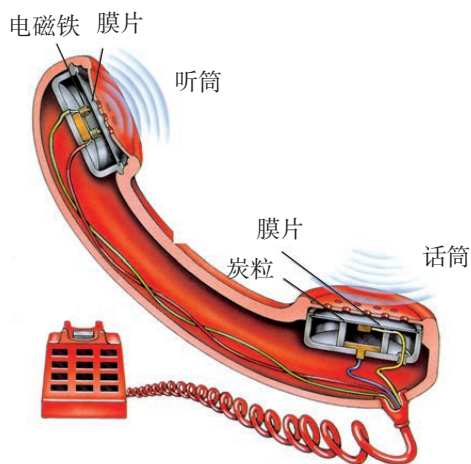
图 17.1-3 电话结构示意图
