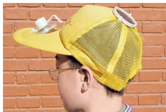
图 18.3-6 太阳能凉帽。电池板把太阳能转化为电能，从而驱动电动机。
