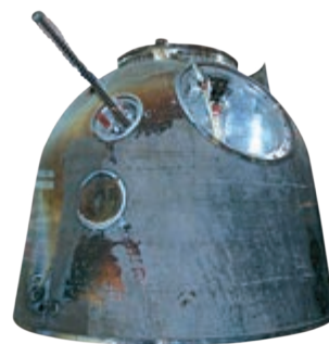
图 5-5 宇宙飞船返回舱烧蚀后的外壳
