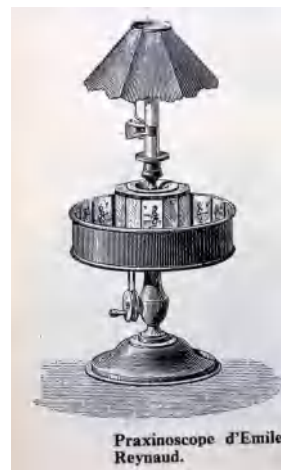
埃米尔·雷诺于1877年发明光学影戏机，奠定了动画的技术基础，是动画放映系统最早的雏形。
