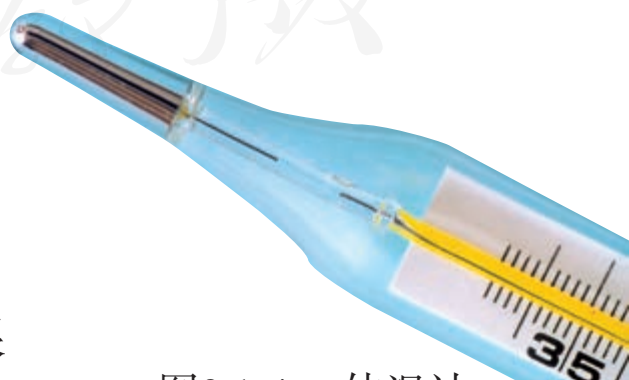
图3.1-4 体温计 （细管处水银柱断开）
