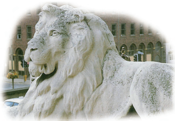
遭受酸雨腐蚀的大理石雕像
