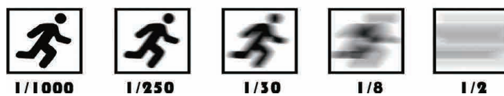
快门速度与运动物体清晰度的关系示意图
