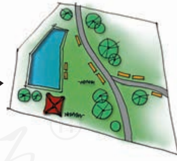
步骤五：设置活动设施，如可在道路沿线安放座椅，在主要景观附近安置休息凉亭等
