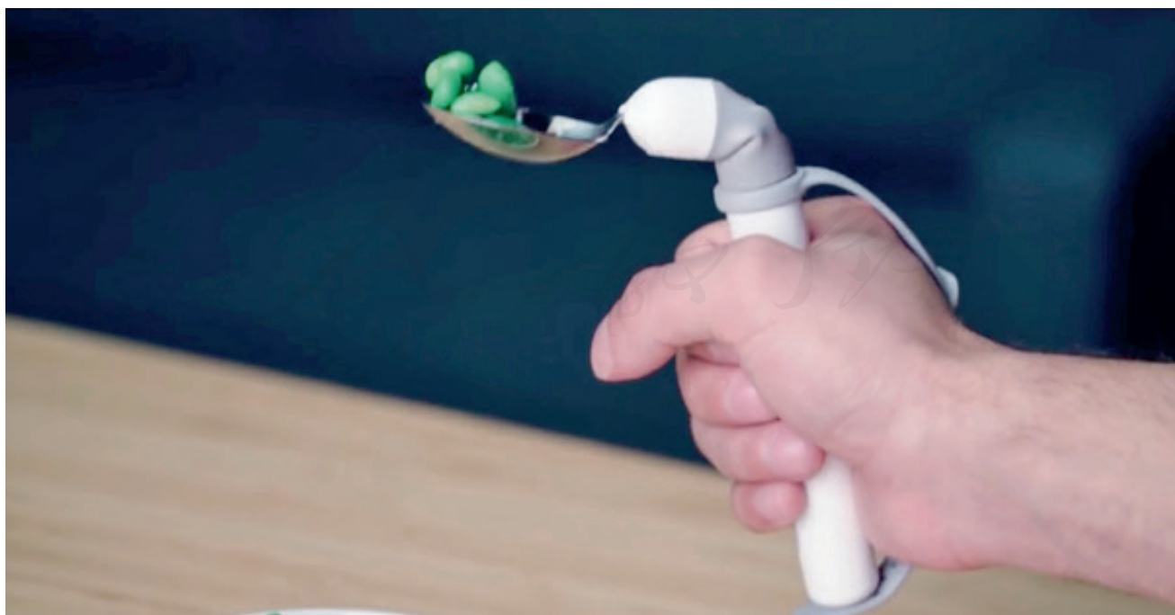
◇ 智能勺子水平握持技术让勺子上的食物不因手抖而撒落。对于患有帕金森的患者来说，这是一个福音。不管你拿着的时候怎么颠它，它的勺子部分始终是稳定的，食物并不会撒出去。
